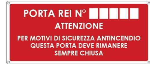
Con la sigla REI si identifica un elemento costruttivo resistente al fuoco che deve conservare un bene per un determinato tempo attraverso tre elementi
